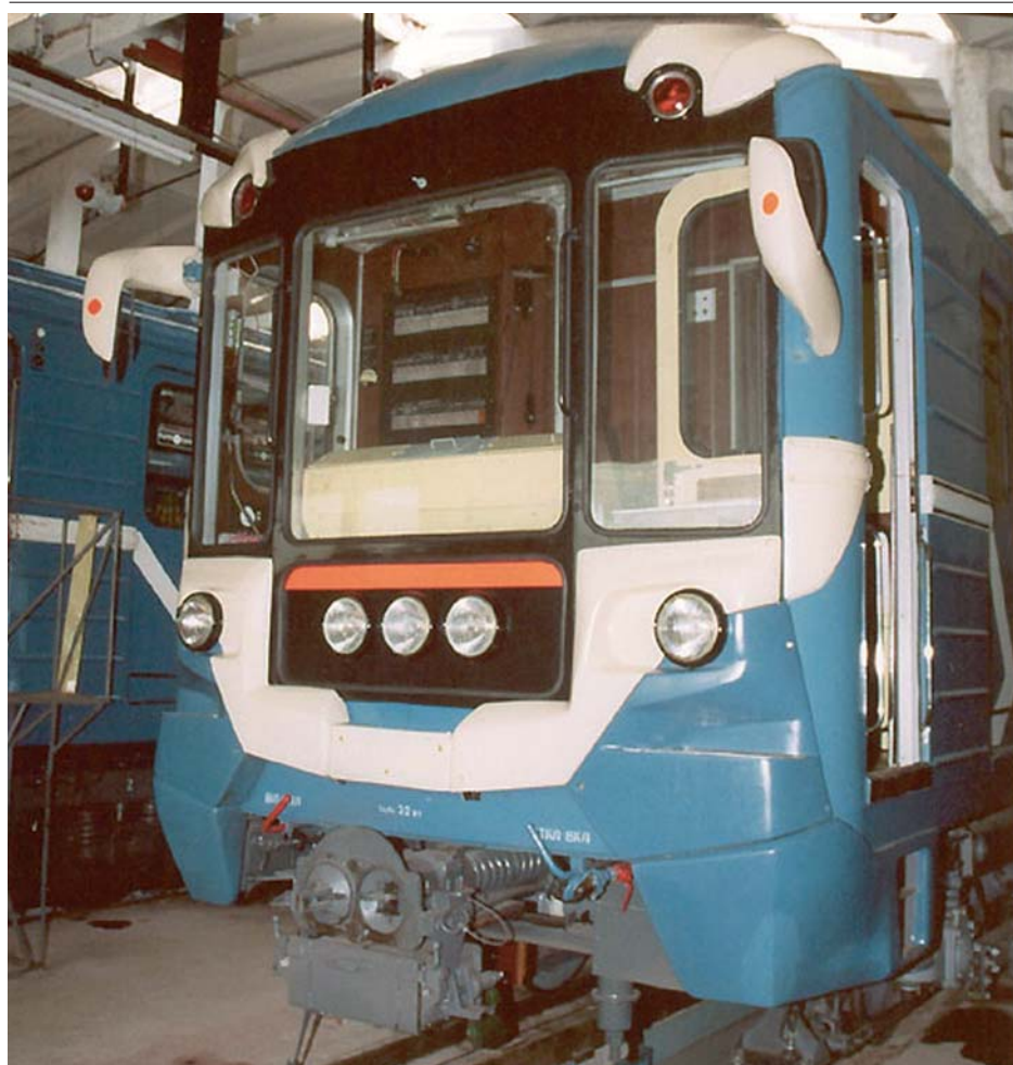
Внешне головные вагоны 81-540.7 отличаются пластиковыми накладками на кабине
